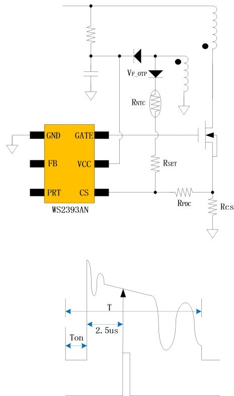
在功率管关断后的去磁时间段，由于辅助绕柱上的电压相对恒定（耦合输出电压），通过如图所示的电路实现方式，可以用来进行外置系统 OTP 的设计。WS2393AN 在 CS 的引脚设计了一个 0.3V 的阈值电压，当检测到 CS 的电压高于 0.3V ( $V_{OTP\_TH}$ )，经过 60ms 的缓冲时间，系统将会关断功率管，同时系统进入自动重启模式。外置系统 OTP 的设计可以通过以下公式给出。
