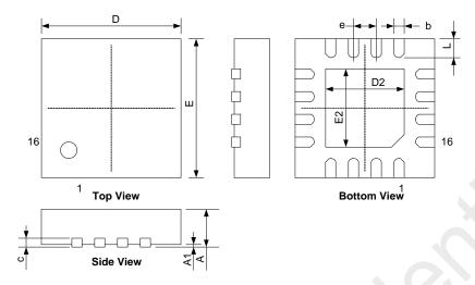
Figure 2. 16-Pin QFN 3x3 Package
