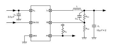
XC9267C75Cxx (V<sub>IN</sub>=12V, V<sub>OUT</sub>=5V, f<sub>OSC</sub>=1.2MHz)
