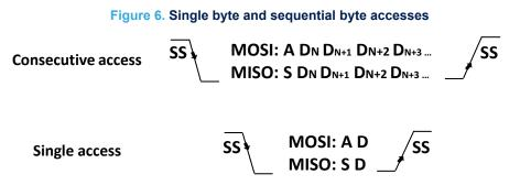
KEY: A: Address byte, D: Data byte, S: Status byte
