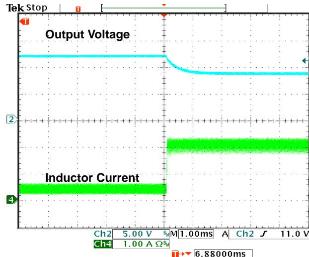
$V_{IN}=3.3V$ ,  $V_{OUT}=12.5V$ ,  $I_{OUT}=10mA$ ,  $L=10\mu H$ ,
