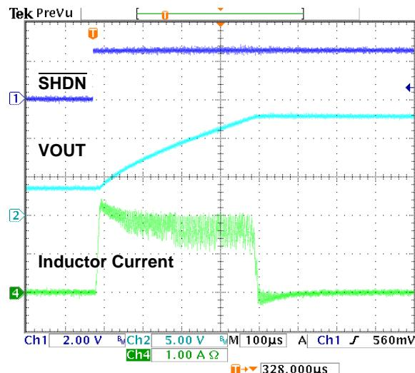
$V_{IN}=3.3V$ ,  $V_{OUT}=12.5V$ ,  $I_{OUT}=10mA$ ,  $L=10\mu H$ ,  $C_3=33nF$ ,
